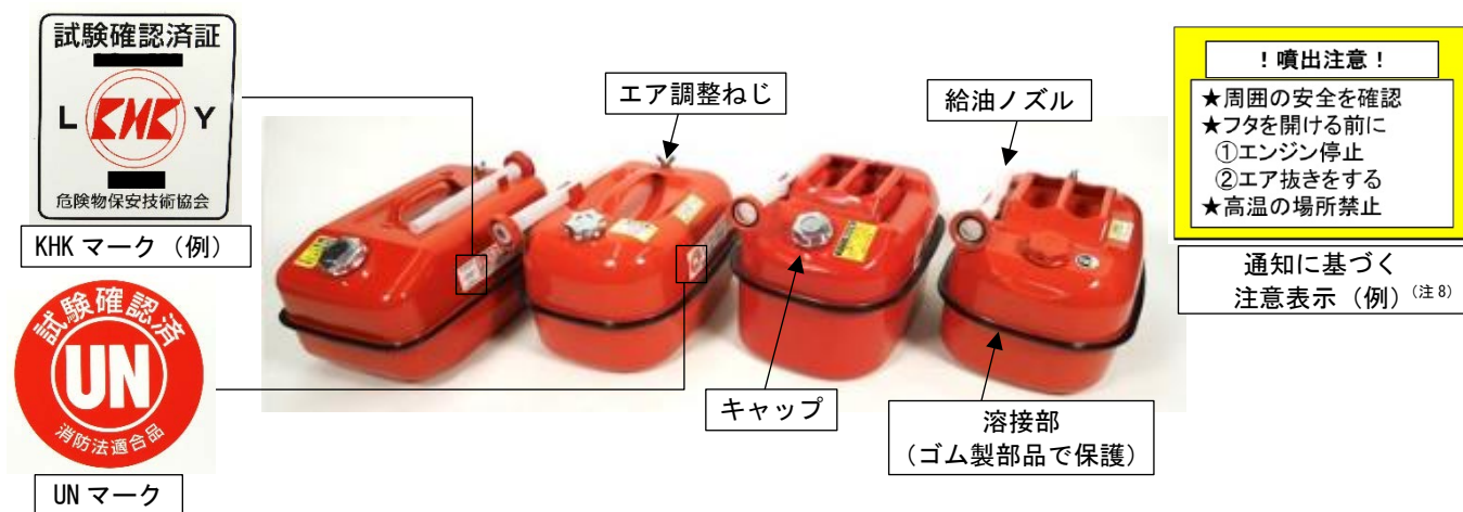
写真1. ガソリン携行缶の外観及び各部の名称 (例)
